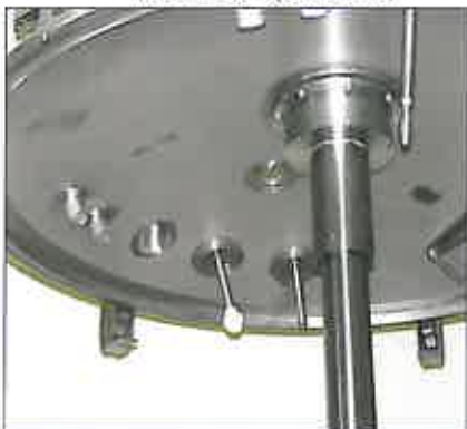
Dessous de couvercle avec injecteurs de nettoyage pour le nettoyage principal et intermédiaire
