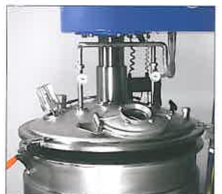
Système de couvercle étanche au vide avec trappe de remplissage et hublot
