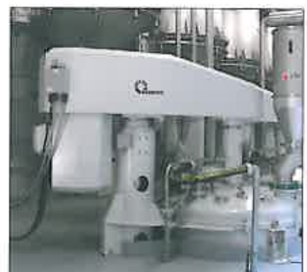
Vacuum-KREIS-DISSOLVER® pour des procédés de production entièrement automatiques
