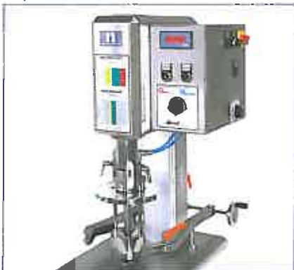
KREIS-BASKET-MILL®, Type KBM/KDV 30-3,0 pour le laboratoire
